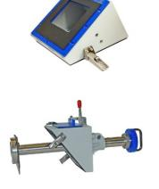
Accessoire pour les essais selon PSA D24 1312, pour un angle d'impact vertical à 90°.
