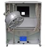
Armoire d'impact RIMpact II VDA pour les essais de simulation d'impact de pierre sur des jantes/roues jusqu'à 26" de diamètre x 335 mm de largeur (en tenant compte de l'angle d'impact de 54° prescrit par le VDA, en liaison avec la distance de tir correcte). Le dispositif de maintien variable permet de positionner l'échantillon à la verticale ou de l'incliner.
