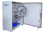
Armoire d'impact RIMpact I VDA, la jante à tester est fixée de manière rotative, de sorte que chaque rayon peut être testé différemment, au choix, avec différentes combinaisons de gravier, de cycles de tir, de quantités de gravier, de périodes de tir et de pressions de tir (sous un angle d'impact de 90°).
